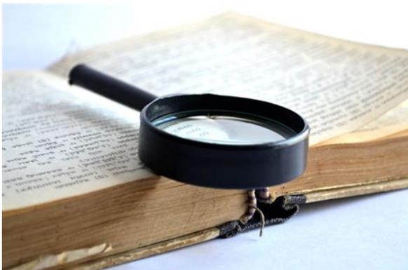
Die Lupe besteht aus einer oder zwei Linsen und erzielt **maximal 25-fache Vergrößerungen**. Mit der Lupe können Gegenstände betrachtet werden, die von blossem Auge nicht erkannt werden und mit einem Lichtmikroskop zu stark vergrößert würden.
